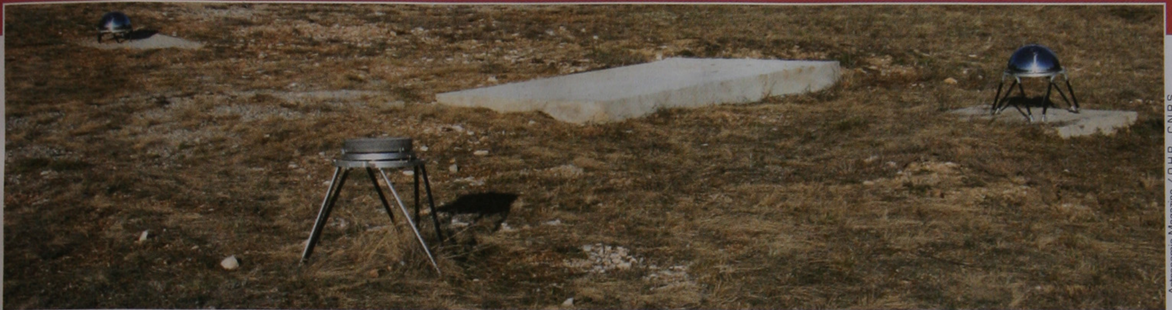
Les petits miroirs de Carlina sont fixes. Ils sont faciles à construire et ne nécessitent pas de monture sophistiquée. Les premiers tests se feront sur trois miroirs de 250 mm espacés de 10 m. Le miroir du premier plan est découvert, les deux autres sont protégés par un cache sphérique.
