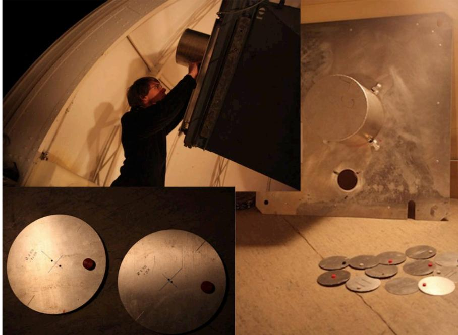
FIGURE 5.3 – Une grande plaque masque l'entrée du tube du T80 (en haut à droite). Un trou dans cette plaque laisse une petite ouverture circulaire d'environ 15 cm pour mettre les masques à 2 trous (en bas à gauche).
